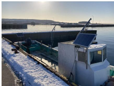
写真 2-1 養殖船に設置された太陽光パネル
