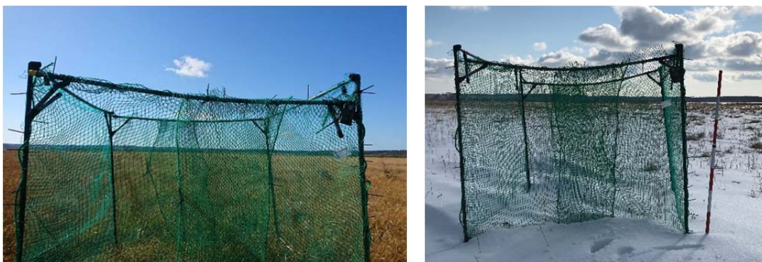
図5 柵上部の塩化ビニル管が外れている様子 (地点C 左:2018年10月21日、右:2019年3月17日)
