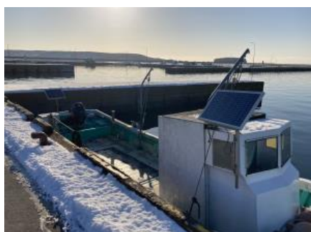
写真 2-1 養殖船に設置された太陽光パネル
